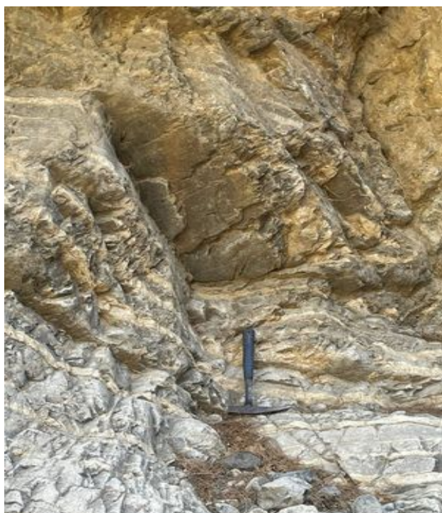
ΕΙΚΟΝΑ 8 Θέση 6 Σαμαριά. Ξεκάθαρα ανθρακικούς σχηματισμούς ανακρυσταλλωμενοι ασβεστόλιθοι-μάρμαρα πιθανότατα υποκείμενα του Γκιγκιλον, ενδιαστρώσεις διοξειδίου του πυριτίου και πολύ έντονα πτυχωμενα. Όσον αναφορά το δείγμα sam 06 έχει γκριζο χρώμα. E:00493730 N:03906750 Ακρίβεια 35 feet Ύψος 705 m
