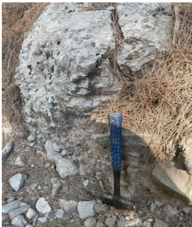
ΕΙΚΟΝΑ 5 Θέση 1 Σαμαριά Ανθρακικές σχηματισμός- πιθανότατα ασβεστόλιθος Ανήκει στα στρώματα του Γκιγκιλου (Τρυπαλι Πλακωδων ασβεστόλιθων Στρώματα Γκιγκιλου) E:00492411 N:03906824 Ακρίβεια 26feet Ύψος:1142Μ
