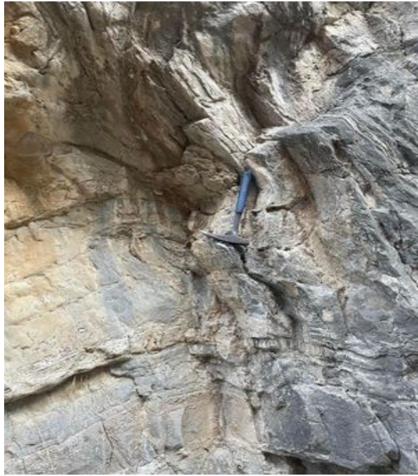
ΕΙΚΟΝΑ 18 Θέση 16 Σαμαριά. Μάρμαρο λεπτόστρωματοδη έντονα πτυχωμένα με κερατολιθικές ενστρώσεις που παρουσιάζει σαφή στρώση με κλίση προς τον νότο μικροκρυσταλλικό E:00496486 N:03903906 Ακρίβεια 100 Ύψος:335
