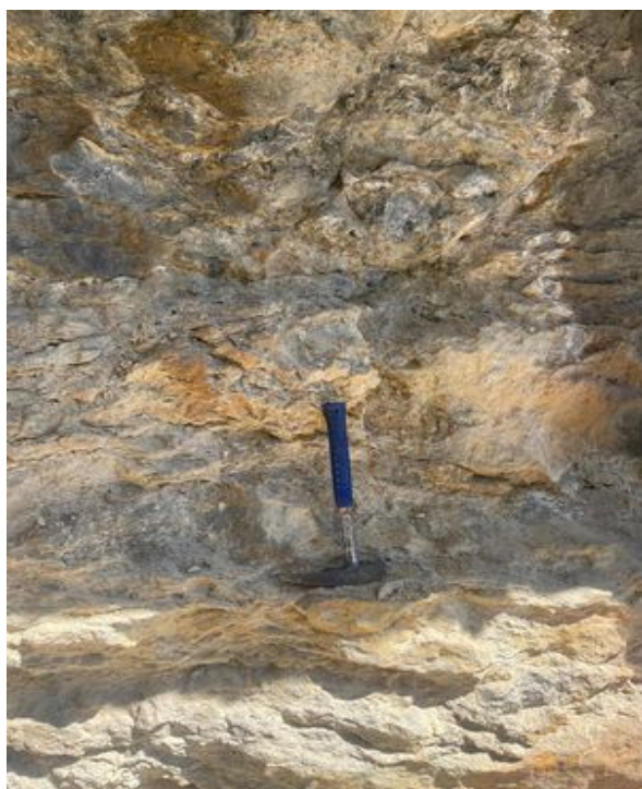
ΕΙΚΟΝΑ 5 Θέση 1 Σαμαριά Ανθρακικές σχηματισμός- πιθανότατα ασβεστόλιθος Ανήκει στα στρώματα του Γκιγκιλου (Τρυπαλι Πλακωδων ασβεστόλιθων Στρώματα Γκιγκιλου) E:00492411 N:03906824 Ακρίβεια 26feet Ύψος:1142Μ
